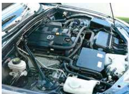
ロードスター不変のエンジン縦置きレイアウト
